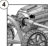
Conecte la manguera Uberflex al conector de salida de agua.
