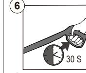
Laissez couler l'eau pendant 30 secondes alors que le moteur est en position OFF (arrêt). Cela permet d'évacuer l'air du réservoir et des conduites.
