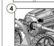
Branchez le tuyau ultraflexible au raccord de sortie d'eau.
