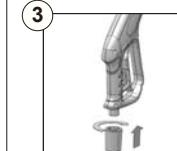
Insérez le tuyau ultraflexible dans la poignée de déclenchement.
