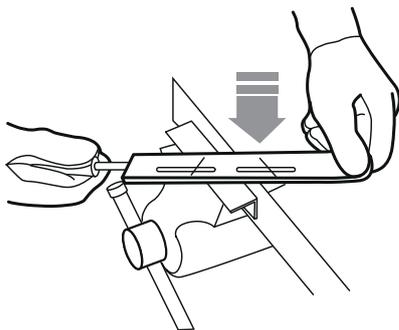
3. Afile la placa superior, la placa lateral y el calibrador de profundidad con una lima plana.
