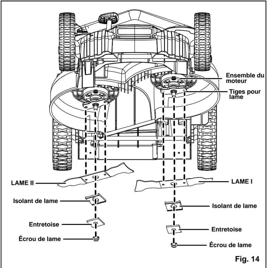
doivent s'insérer dans leur trou respectif sur la lame. Assurez-vous que les bouts incurvés soient orientés en direction du châssis de la tondeuse et non en direction du sol. Une fois bien appuyée, la lame devrait être à plat contre l'ensemble moteur.
