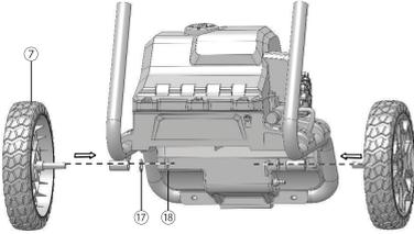
1. Insérez un essieu dans la roue et le cadre de la poignée.
