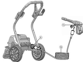
1. Poussez et tournez dans le sens des aiguilles d'une montre l'une des extrémités du tuyau haute pression dans le coupleur d'entrée.
