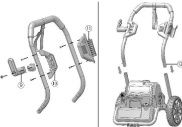
1. Alignez les manchons de vis du support du pistolet aux trous de vis sur la poignée supérieure.
