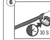
Laissez couler l'eau pendant 30 secondes alors que le moteur est en position OFF (arrêt). Cela permet d'évacuer l'air du réservoir et des conduites.
