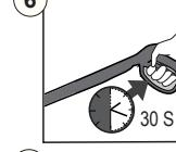
Deje correr el agua de la manguera por 30 segundos sin llevar el motor a la posición de encendido (ON). Esto ayuda a sacar el aire del tanque y las líneas.
