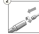
Una la pistola de la hidrolavadora a presión a la lanza de pulverización.
