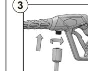
Raccordement du tuyau à haute pression à la poignée de la gâchette.
