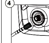
Raccordez le tuyau à haute pression au raccord de la sortie d'eau.
