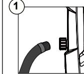
Raccordez le tuyau d'arrosage à la prise d'eau de la laveuse à pression.
