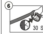
Laissez couler l'eau pendant 30 secondes alors que le moteur est en position OFF (arrêt). Cela permet d'évacuer l'air du réservoir et des conduites.
