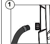
Una la pistola de la hidrolavadora a presión a la lanza de pulverización.
