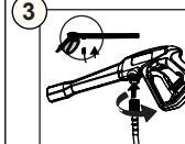
Raccordement du tuyau à haute pression à la poignée de la gâchette.
