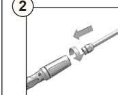
Una la pistola de la hidrolavadora a presión a la lanza de pulverización.
