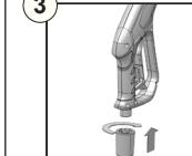
Insérez le tuyau ultraflexible dans la poignée de déclenchement.
