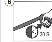
Deje correr el agua de la manguera por 30 segundos sin llevar el motor a la posición de encendido (ON). Esto ayuda a sacar el aire del tanque y las líneas.
