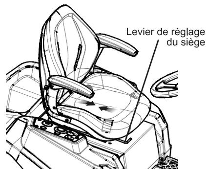
1. Asseyez-vous sur le siège et soulevez le levier de réglage du siège.
